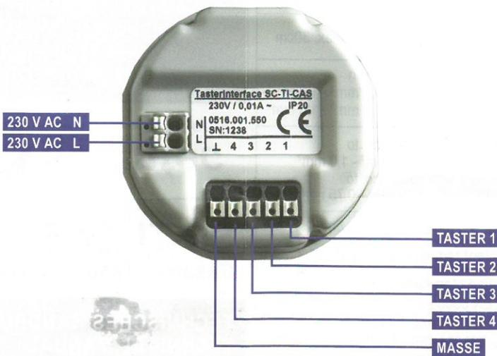
**ACHTUNG:** Die Tastereingänge dürfen NICHT mit einer EXTERNEN Spannung beaufschlagt werden! Ein Nichtbeachten führt zu einer irreversiblen BESCHÄDIGUNG des Tasterinterface!
